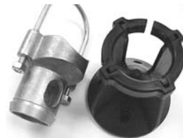
注意喷嘴底部的凸槽轮廓
